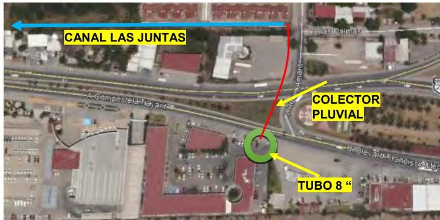
Obras hidráulicas de plaza las juntas y gasolinera
